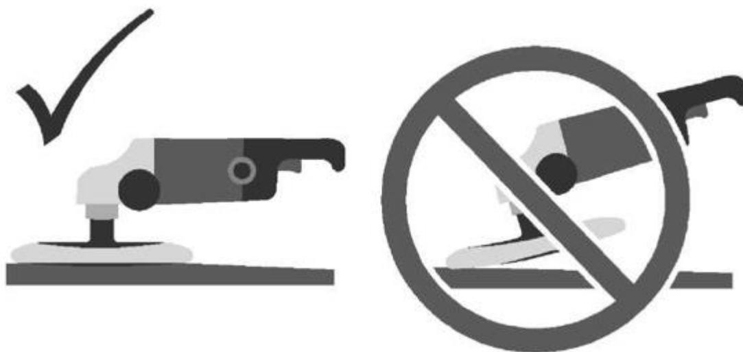
**Рисунок А: угол полировки**
